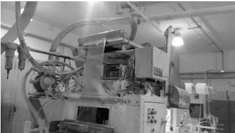
Eletrodo com solda térmica e sistema de guilhotina:
